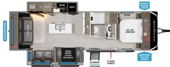
**2970RL**    UVV'<sup>1</sup> **7,880**    HITCH'<sup>1</sup> **809**    LENGTH'<sup>2</sup> **33' 11"**    HEIGHT **11' 3"**    CAPACITY **45 90 45**
