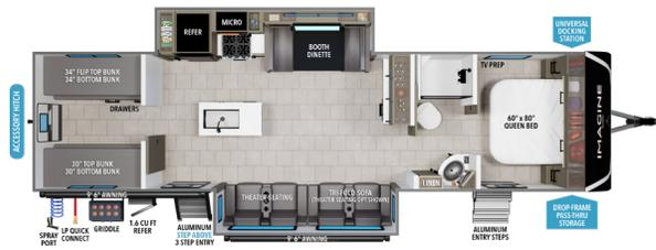
**3210BH**    UVV'<sup>1</sup> **8,725**    HITCH'<sup>1</sup> **947**    LENGTH'<sup>2</sup> **36' 8"**    HEIGHT **11' 3"**    CAPACITY **45 90 45**
