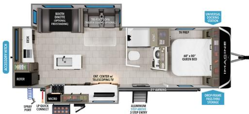
**2670MK**    UVV'<sup>1</sup> **6,884**    HITCH'<sup>1</sup> **776**    LENGTH'<sup>2</sup> **32'**    HEIGHT **11' 2"**    CAPACITY **45 82 45**
